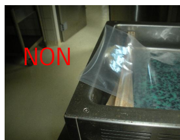
Photo 5 : positionnement incorrect du sachet
