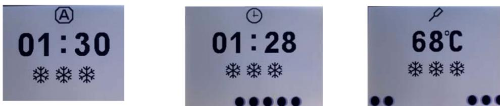
Une fois le programme terminé, la cellule de refroidissement rapide passe en mode stockage. Une alarme va alors retentir ; appuyer sur le bouton et le relâcher pour arrêter l'alarme. Si l'alarme n'est pas arrêtée, la cellule de refroidissement rapide va néanmoins passer en mode stockage, l'alarme retentissant à intervalles réguliers. Pour arrêter l'alarme, appuyer sur le bouton et le relâcher.
