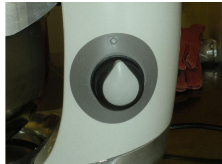
Photo 3 : détail du régulateur de vitesse
