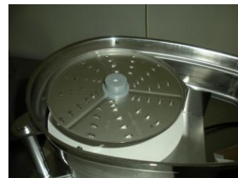
Photo 5 : position du disque de coupe sur le disque récupérateur
