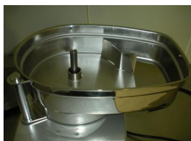
Photo 3 : position du plateau sur le bâti moteur
