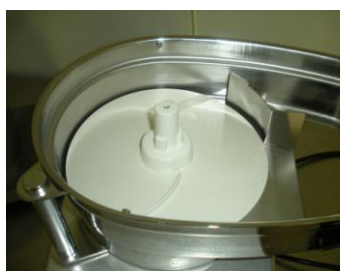
Photo 4 : position du disque récupérateur dans le plateau
