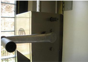
Photo 1 : manivelle positionnée sur la crémaillère à vitesse rapide, pression faible
