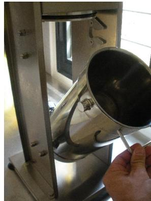
Photo 4 : bascule du cylindre sur ses supports bas
