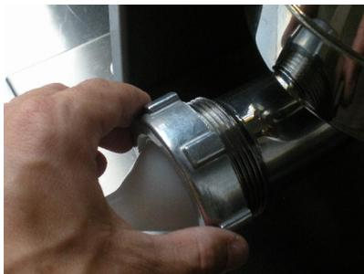
Photo 5 : vissage de l'embout sur le bas du cylindre
