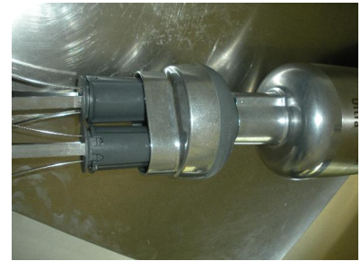
Photo 6 : liaison moteur - support des fouets - fouets
