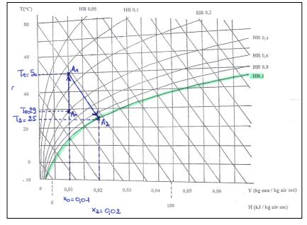
Cet air a une température T<sub>2</sub> et une humidité relative x<sub>2</sub>.
